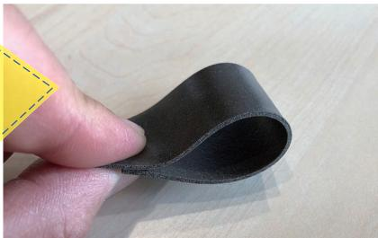
塗膜が有機質と無機質の結合体であるため、熱や寒さによる影響が少なく、温度変化抵抗性があります。また、適度な伸び弾性および引張強度があるため床版・アスファルト舗装の挙動に一体的に追従します。そのため、荷重負荷による防水層の損傷・欠陥が発生しにくくなります。
