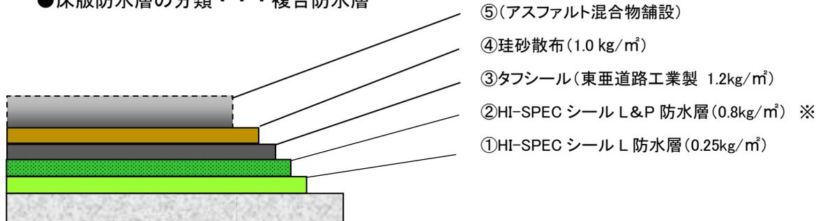
※床版面の凹凸の状態によっては、2層目の塗布量を増量してください(25%増し程度まで)。
