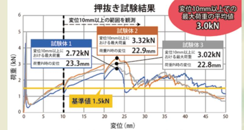
試験方法：JSCE-K 533-2013 コンクリート片のはく落防止に適用する表面被覆材の押抜き試験方法（土木学会規準）
