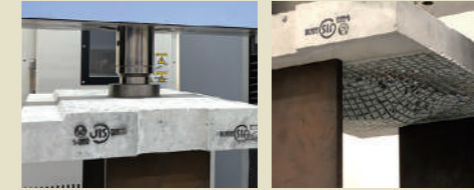
コンクリート試験体が押し抜きされている様子
