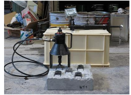
接着力試験状況
