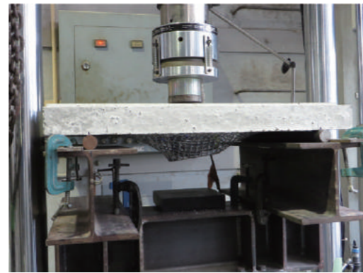
押し抜きせん断試験の様子 (試験データは裏表紙参照)
